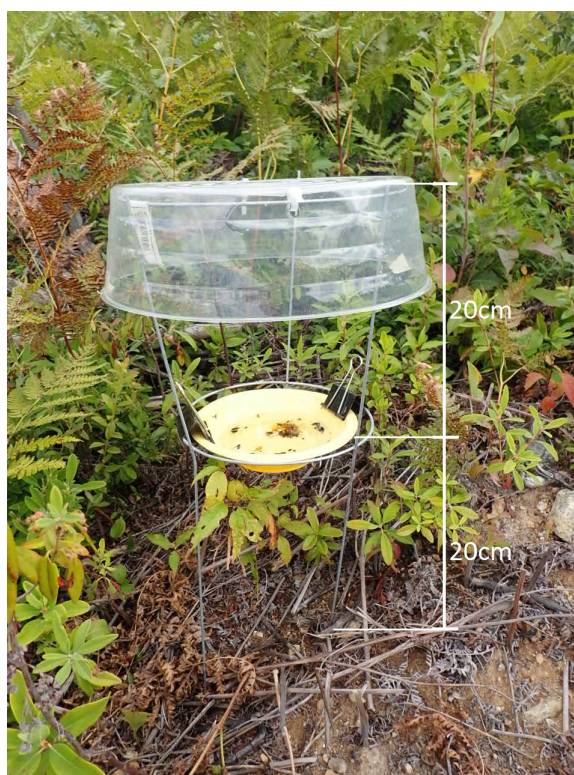
FIGURE 7 – Photo des pièges à coupelles colorées utilisés pour l'échantillonnage des syrphes. Le piège est composé de deux parties principales : les coupelles colorées, placées à une hauteur de 20 cm au-dessus du sol, fixées dans une cage à tomates, et une soucoupe en plastique transparent, positionnée 20 cm au-dessus des coupelles, pour protéger la solution de propylène glycol des précipitations.
