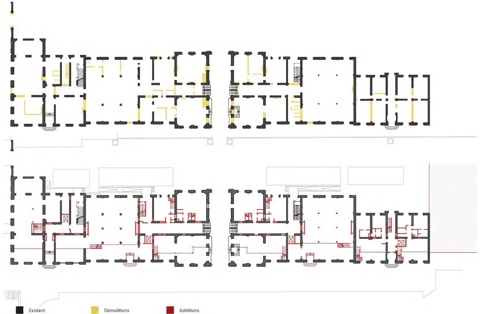
Fig. 52 Plans du rez-de-chaussée inférieur existant-projeté. Échelle 1/500
