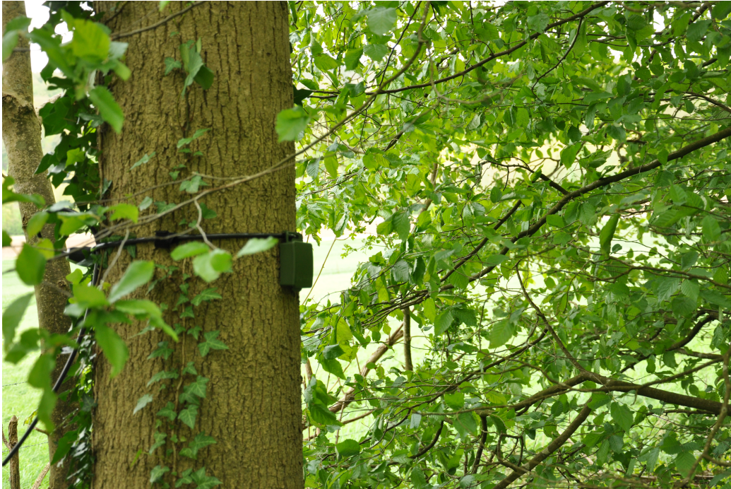
Enregistreur acoustique installé dans une lisière. Photo : Rémy Driesen
