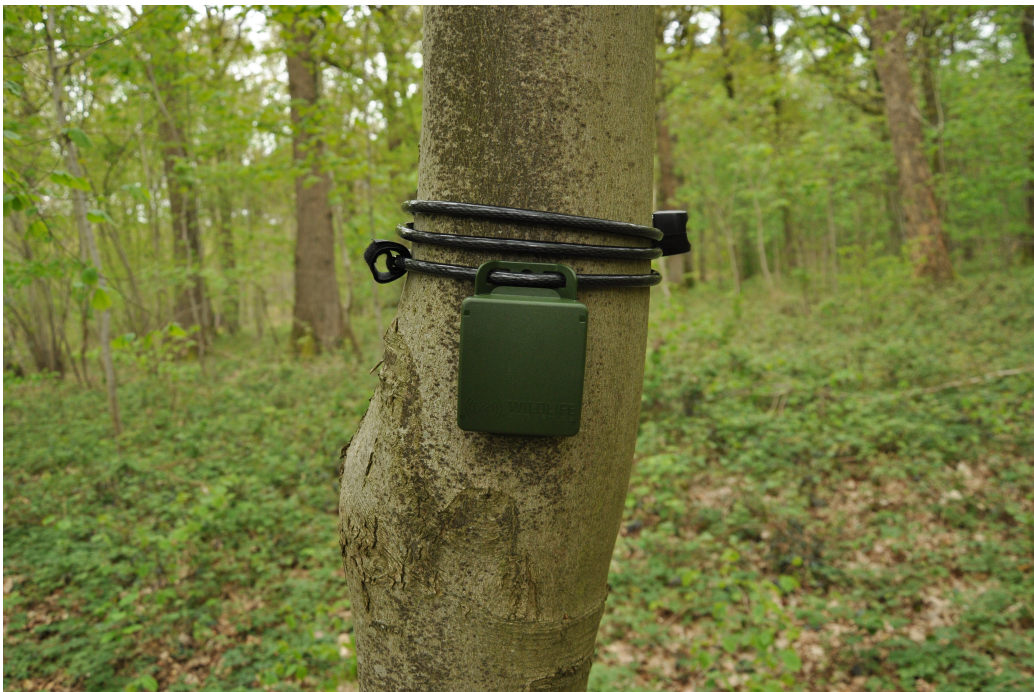
FIGURE 9 – Micro SMM1 installé sur un arbre
