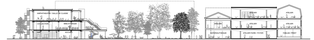
Coupe sur le Learning Center: les plateaux entourent l'existant et abritent la bibliothèque et l'auditorium
