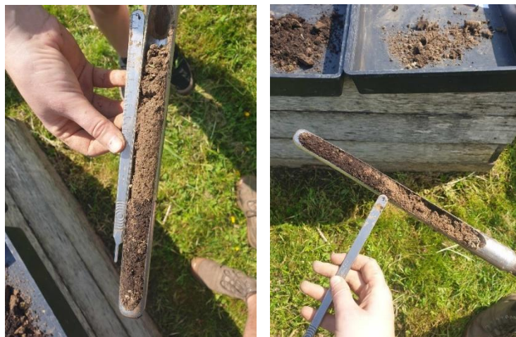
Figure 9 : Prélèvements du sol avec une tarière et séparation visuelle des échantillons en deux horizons.
