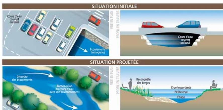
Figure 6 : Exemple de remise à ciel ouvert avec la situation initiale et la situation projetée
