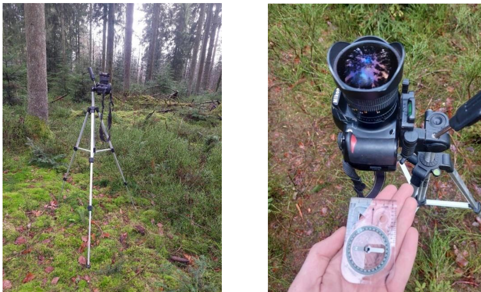
Figure 54 Photographies de l'appareil photo à objectif hémisphérique
