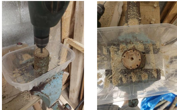
Figure 49 Photographies du procédé de production de sciure
