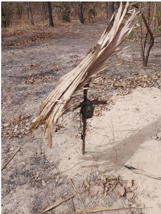
Figure 15 : Photographie du système de protection solaire mis en place sur les caméras exposées au soleil.
