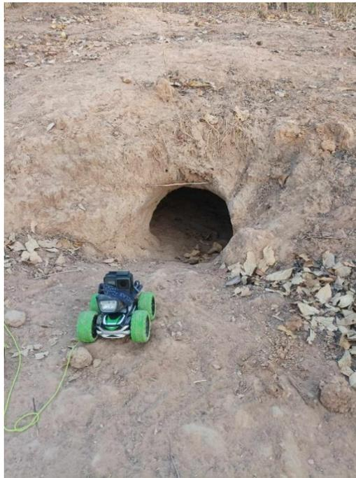
*Figure 12 : Photographie de la voiture télécommandée munie d'une caméra utilisée pour l'exploration des terriers.*
