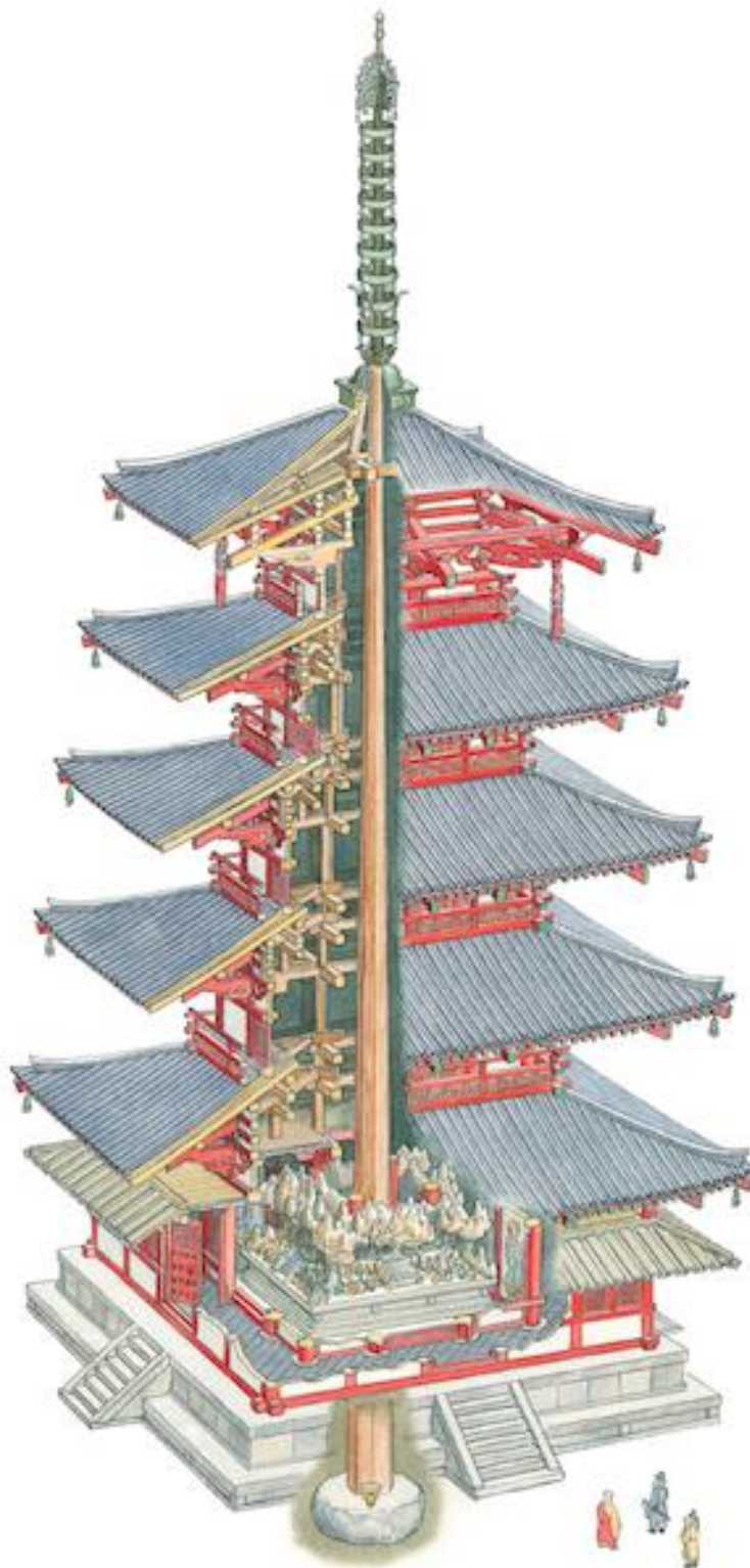
Figure 42 Schéma de la plus ancienne pagode existante au Japon, Hōryū-ji, période Asuka, Antiquité. Les pagodes ne possèdent pas d'étages accessible ©Gentaro Kagawa
