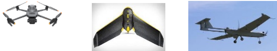
FIGURE 2 – Exemples de drones. De gauche à droite : drone multiroteur DJI Mavic 3M, drone à aile fixe léger, drone à aile fixe lourd.
