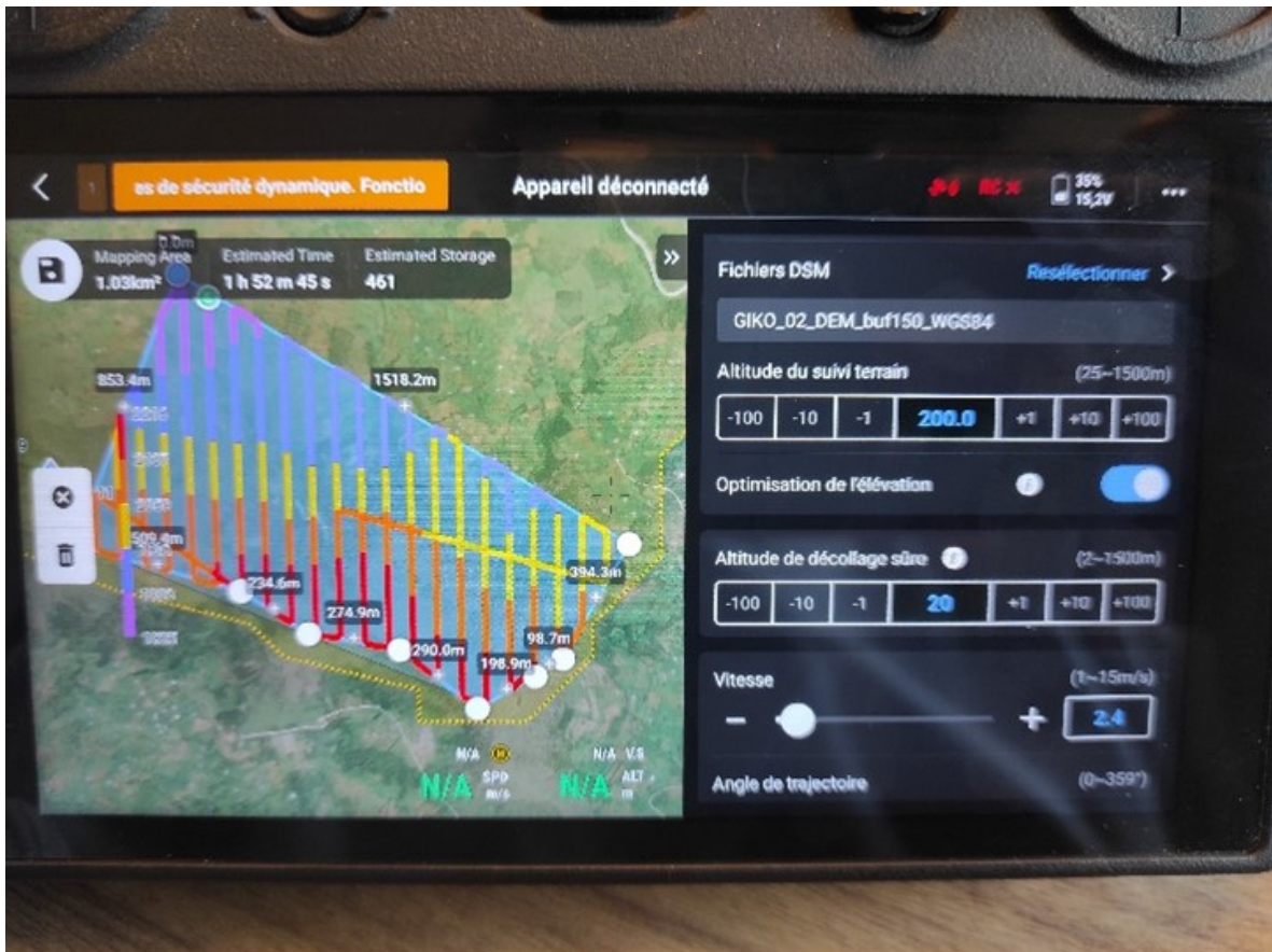
Figure 17 : Réglage de l'altitude décollage sûre.
