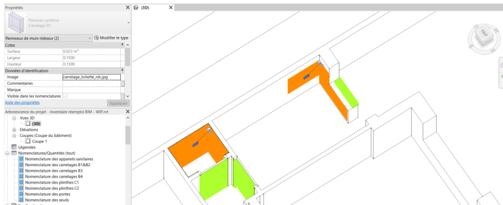
Figure 42 : Visualisation du carrelage B1 avec leur code couleur dans le modèle Revit
