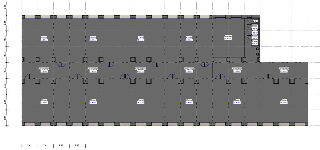
Figure 59 : Exemple d'ajout de groupes pour former la base d'une école modulaire par le chercheur dans Revit.
