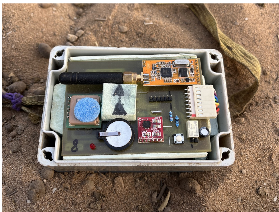
Figure 22: Modèle du collier GPS attaché au coup des chèvres suivies. Source : Photographie personnelle prise le 22 septembre 2024.
