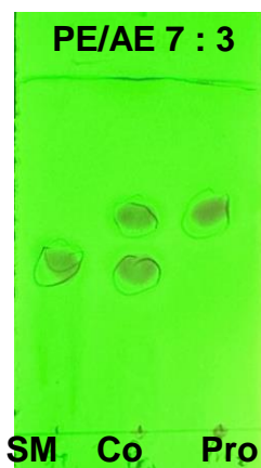
Figure 14: Plaques CCM du suivi réactionnel de la synthèse du 4-iodobenzoate de succinimide avant (gauche) et après (droite) purification.
