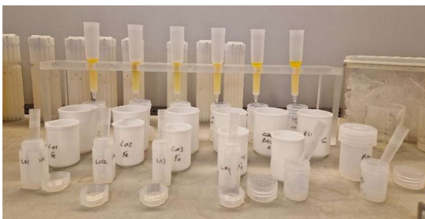
Figure 18 - Séparation sur colonnes avec résines pour le Fe, le Cu et le Zn (photo prise au laboratoire G-Time)
