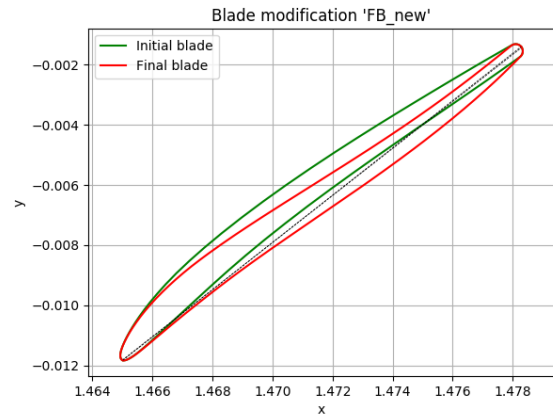
(d) FB comparison with +10° Metal Angle at TE
