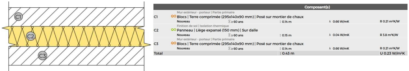
Figure 174 : Mur fictif en terre crue avec du liège généré avec l'outil TOTEM.
