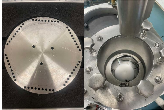
Figure 4 : Photos d'un disque doseur (à gauche) et d'un disque doseur monté (à droite)
