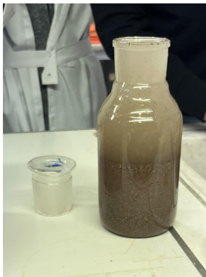
FIGURE 2.19 – Pycnomètre rempli de sable et d'eau
