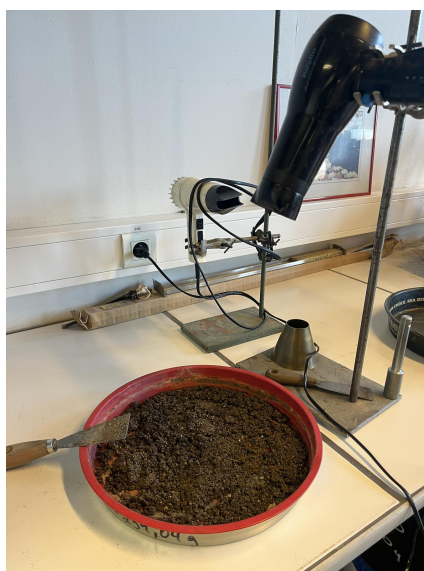
FIGURE 2.20 – Détermination de la masse réelle saturée à surface sèche
