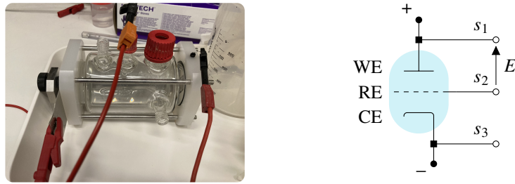
Fig. 3.12 Photographie et schéma des connexions de la cellule analytique à trois électrodes. Les sondes s_1 , s_2 et s_3 sont propres à la constitution du potentiostat (BioLogic, 92).
