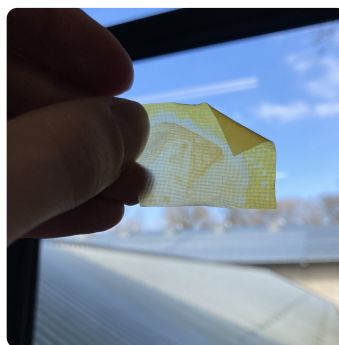
Fig. 4.1 Photographie de l'échantillon F75(2) partiellement désactivé après 24 h d'immersion dans de l'eau désionisée à 95 °C. La coloration plus brunâtre est due aux ions \text{Br}^- qui substituaient à l'origine FAA-3-PK-75. La coloration plus jaunâtre résulte du passage vers la forme \text{OH}^- qui a révélé toute une zone insensibilisée, restée brune.
