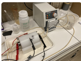
Photographie et schéma des connexions de la cellule analytique à quatre électrodes. Les sondes s_1 , s_2 et s_3 sont propres à la constitution du potentiostat (BioLogic, 92).
