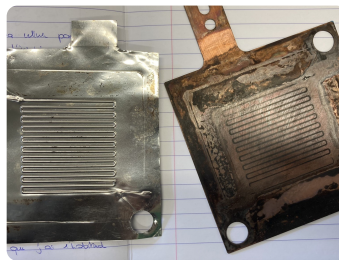
Fig. 3.4 Photographie des plaques bipolaire (en nickel, à gauche) et collectrice (en cuivre, à droite) exposées au courant anodique. Les dépôts noirâtres à la surface du métal ont été attribués à l'oxyde cuivrique \text{CuO} . La plaque bipolaire en nickel n'est pas affectée par la corrosion.
