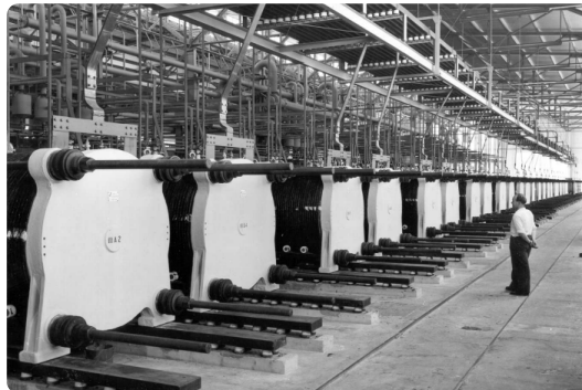
Fig. 2.1 Photographie d'un système (multi- stack ) d'électrolyseurs alcalins d'une consommation totale estimée à 135 MW en opération à Glomfjord en Norvège entre 1953 et 1991 (20).
