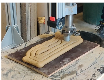
FIGURE 122 – Première couche d'impression du chapiteau
