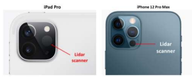
FIGURE 17 – Lidar sur les iPad et iPhone Pro (Abbas & Abed, 2024)
