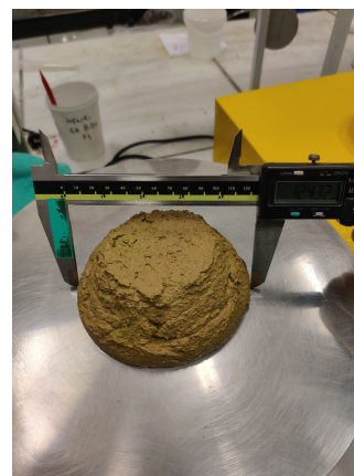
FIGURE 121 – Test d'étalement du second mix
