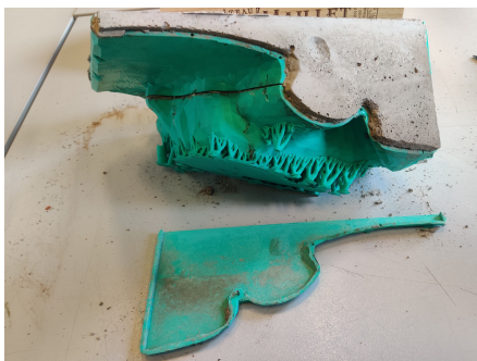
FIGURE 101 – Démoulage des premières parties de la coque
