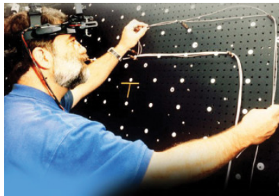
FIGURE 2.8 – Casque de réalité augmentée utilisé dans l'assemblage chez Boeing (1992).
