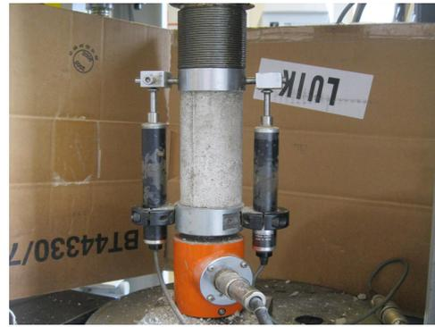
FIGURE 4.12 – Système de compression simple
