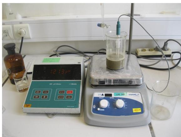
FIGURE 4.4 – Mesure de pH du sol par pH meter
