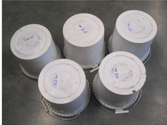
FIGURE 4.7 – Conservation des échantillons dans les seaux inversés
