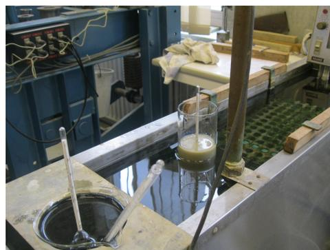
FIGURE 4.2 – Mesure de la densité du sédiment par l'aréomètre dans un bain thermostaté
