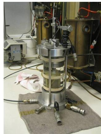
FIGURE 4.15 – Cellule triaxiale au laboratoire
