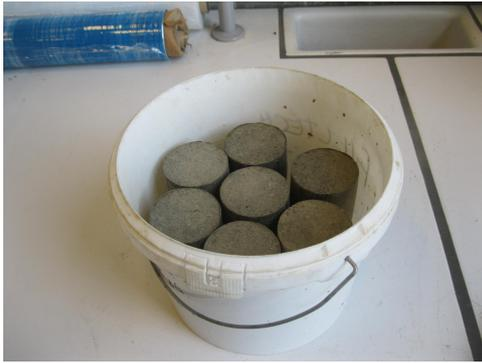
FIGURE 4.11 – Conservation des éprouvettes
