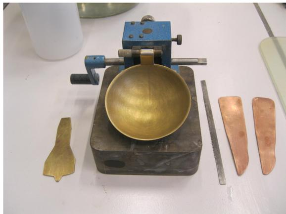
FIGURE 4.3 – Dispositifs d'essai des limites d'Atterberg
