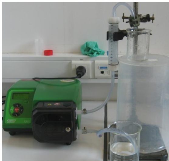
Figure 36 : Modification du montage initial : raccourcissement du tuyau de sortie
