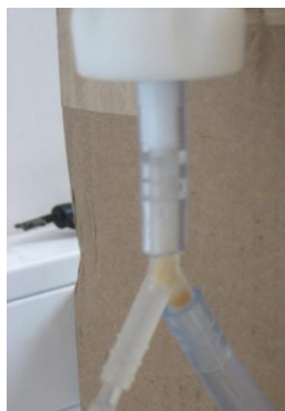
Figure 48 : Adsorption de l'uranine sur la laine de verre lors des essais de traçage à pH 2
