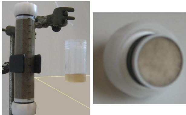
Figure 63 : Passage d'eau Milli-Q à pH 10 à travers la colonne remplie de sable pour bac à sable de Cobo Garden. A gauche : de fines particules de sables sortent de la colonne. A droite : la base poreuse de l'extrémité supérieure de la colonne est remplie de fines particules.
