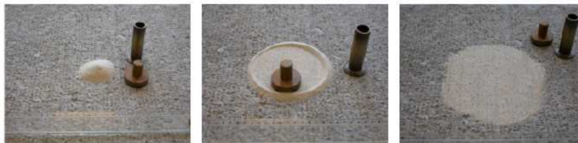
FIGURE 3.3 – Essai à la tache de sable, [Courard, 2011]
