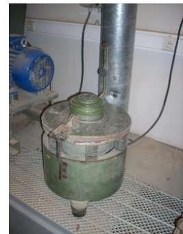
Photo 51 : Broyeur à mâchoires ouvert
