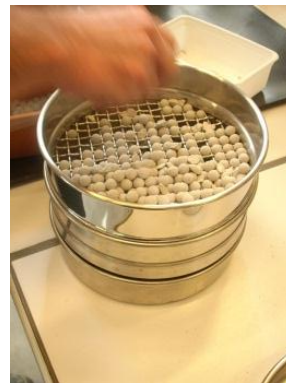
Photo 32 : Enlèvement de la charge abrasive
