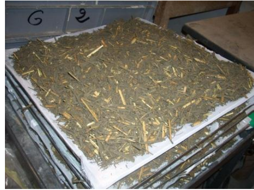
Photo 14 : Mise en place des granulats sur les plaques
