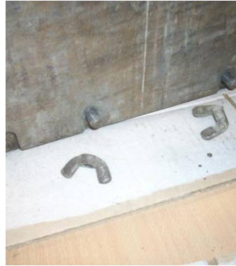
Photo 2 : Vis démontables du moule métallique
