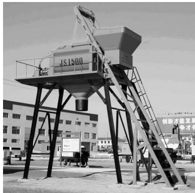
Figure 5 : Malaxeur de matières (Concrete Plant, 2012)
