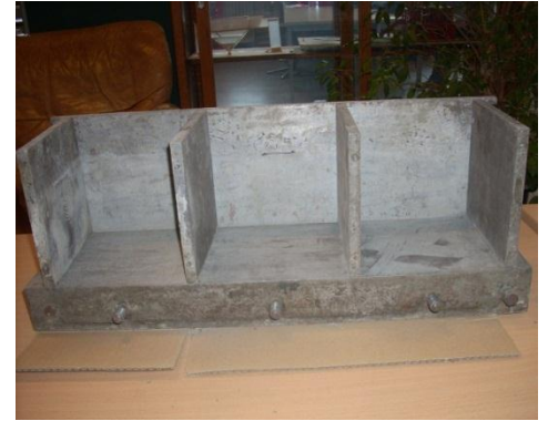
Photo 3 : Parois démontables du moule métallique
