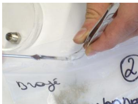
Photo 41 : Mise en place de la poudre broyée dans le creuset
