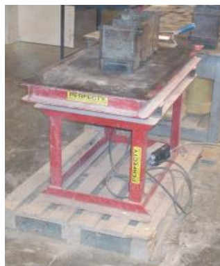
Photo 20 : Table de vibration et moules
