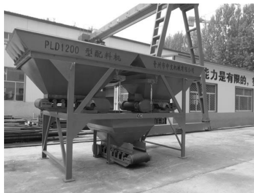
Figure 4 : Doseur de matières (Tower Crane, 2012)
