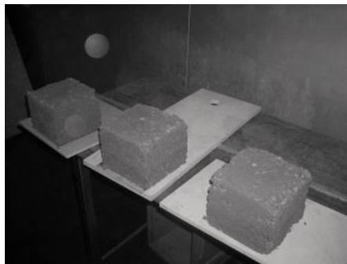
Photo 24 : Blocs de béton dans la chambre humide
