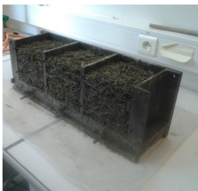
Photo 63 : enlèvement d'une paroi du moule
