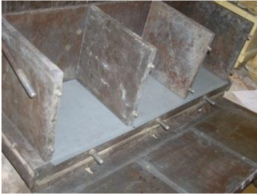
Photo 7 : Placement du Mylar entre les parois
