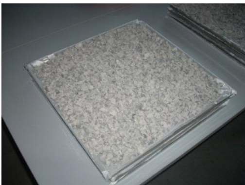
Photo 11 : Granulats posés sur la plaque
