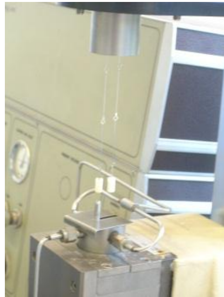
Photo 43 : Creuset de référence et creuset pourvu de poudre
