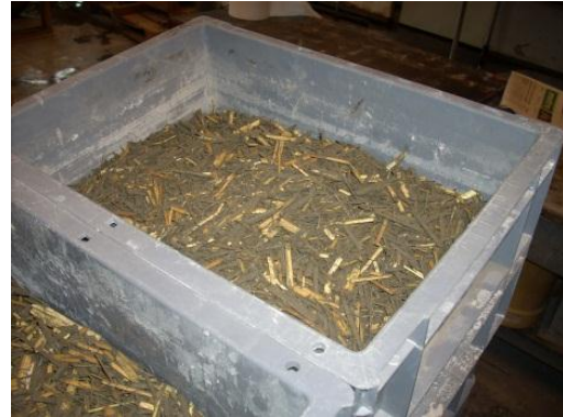
Photo 56 : granulat étalés sur une hauteur de 5 cm.
