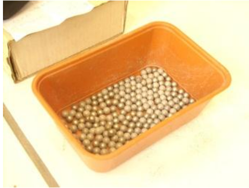
Photo 25 : Billes d'acier – Charge abrasive
