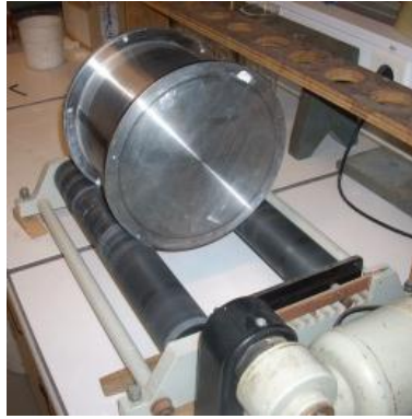
Photo 29 : Mise en place du cylindre sur les deux arbres horizontaux
