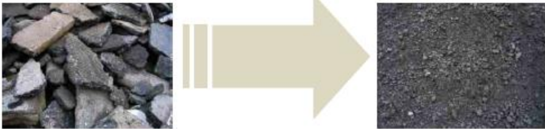
Figure 21 : Granulats de débris hydrocarbonés (Architectes et professionnels du secteur de la construction, 2010)
