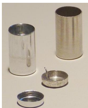
Figure 61 : Creusets dans lequel est déposé l'échantillon de base
