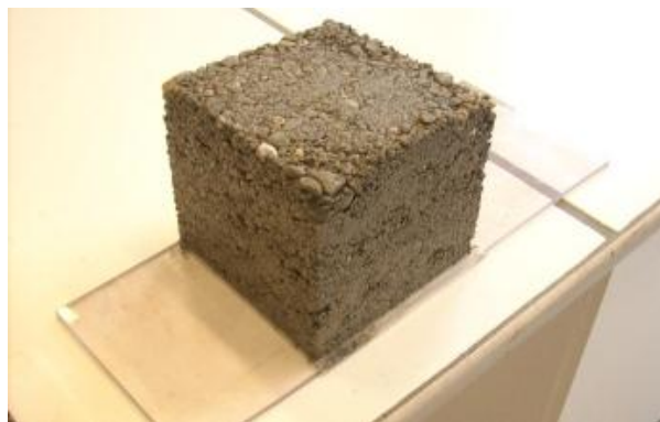
Photo 57 : Exemple de bloc de béton réalisé à base de granulats naturels
