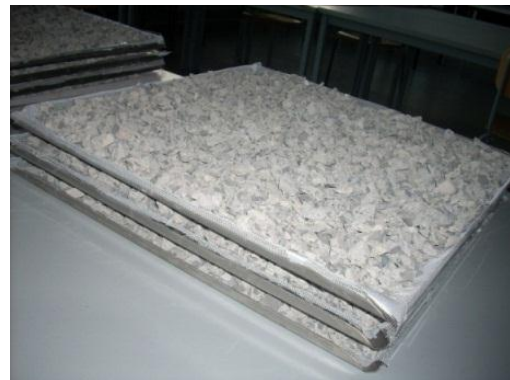
Photo 10 : Mise en place des granulats sur les plaques
