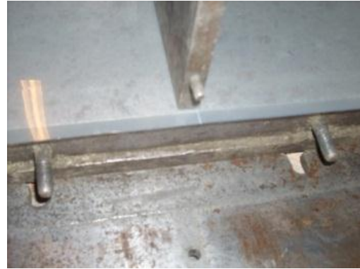
Photo 8 : Dépassement du Mylar pour pouvoir saisir le bloc
