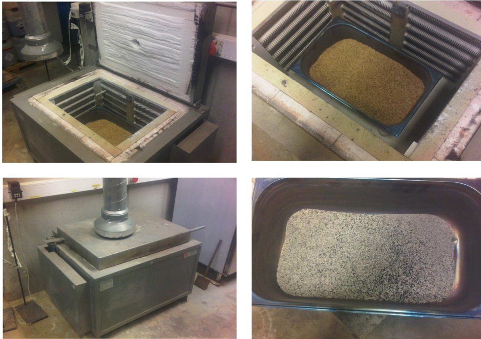
Figure 13 - Four de laboratoire et cendres obtenues après calcination
