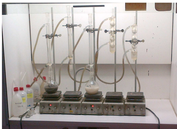
Figure 21 - Montage de l'essai Chapelle en laboratoire
