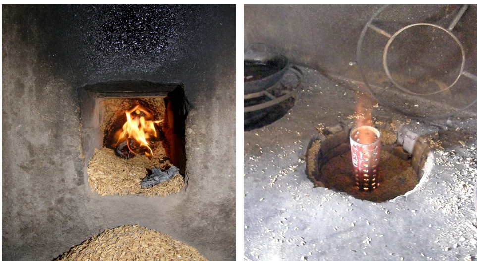
Figure 12 - Combustion de la balle de riz dans le four
