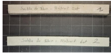
Figure 57 : Barrettes de retrait total LAASR
