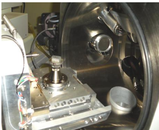
Figure 30 : Echantillon placé sur le socle du tiroir de la chambre du microscope électronique
