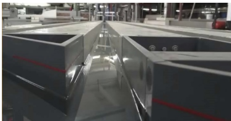
FIGURE 3.2: Galerie idéalisée - photo du modèle réduit [Pummer, 2013]
