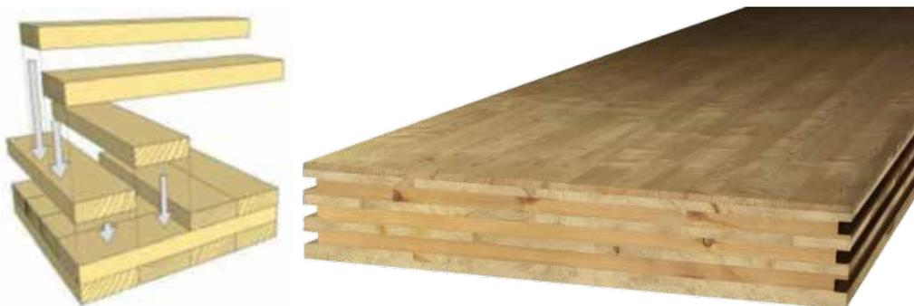
FIGURE 2.23 – PRINCIPE DE L'EMPILEMENT DES LAMES DE BOIS EN COUCHES CROISÉES À 90° [24]
