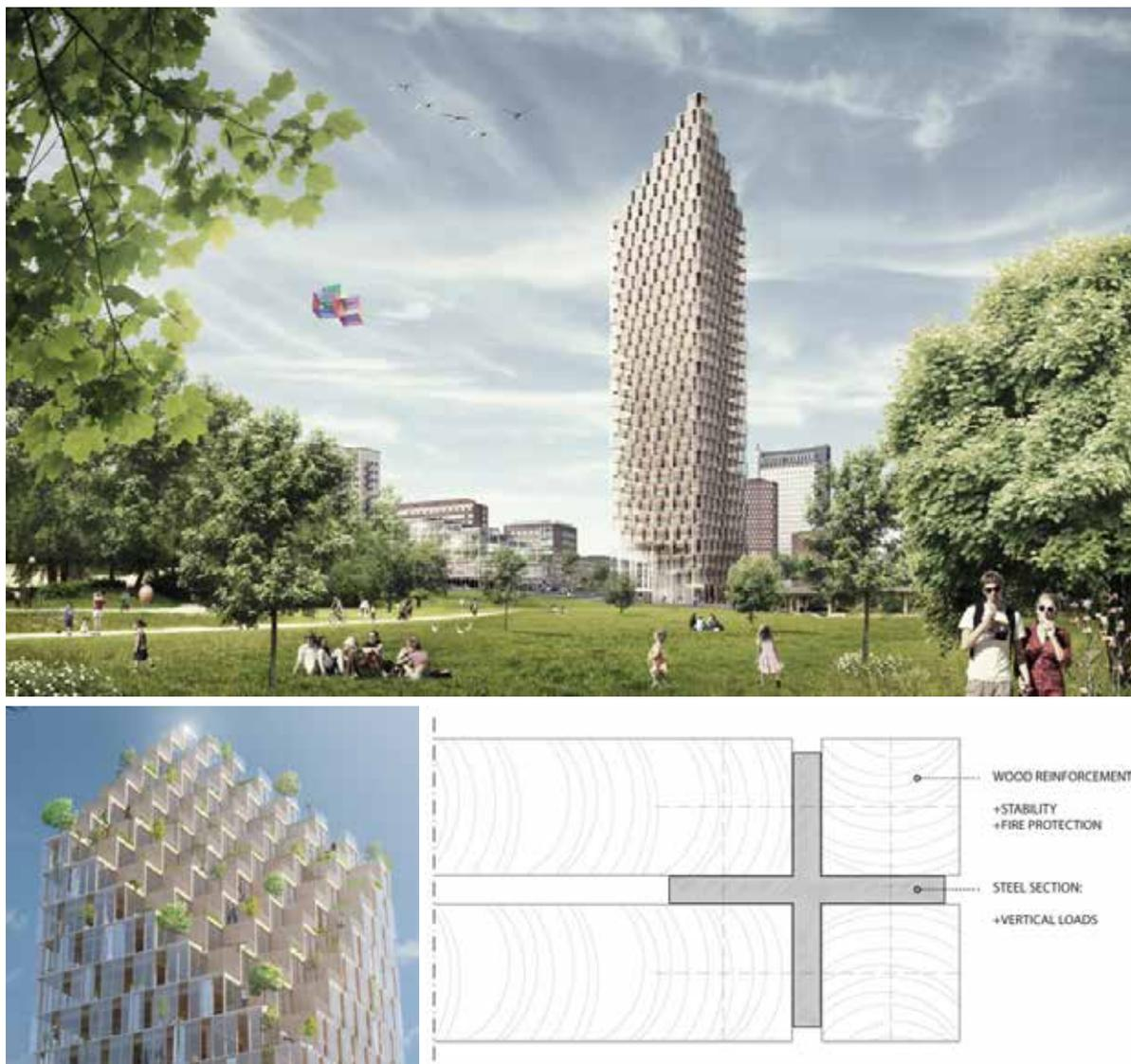
FIGURE 2.22 – PROJET DE BUILDING « WOODEN SKYSCRAPER » À 34 ÉTAGES AU DANEMARK COMBINANT DES PANNEAUX MASSIFS EN BOIS ET DES PROFILÉS EN ACIER [WWW.MATERIA.NL]
