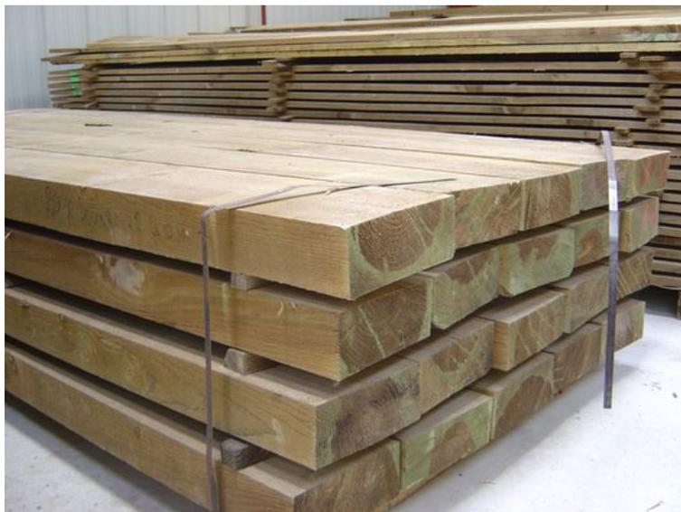
FIGURE 6.3 – DISPOSITION « AÉRÉE » POUR LE STOCKAGE D'ÉLÉMENTS EN BOIS SUR CHANTIER [WWW.PORTAIL-ARTISANS.COM]
