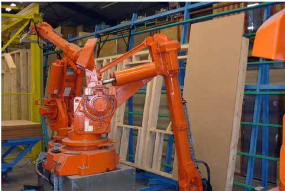
FIGURE 3.1 – CHAÎNE ROBOTISÉE DE MOBIC SA POUR LA CONSTRUCTIONS DE MURS, TOITURES ET CAISSONS DE MAISONS À OSSATURE BOIS [WWW.MYBESTCV2.CO.IL]
