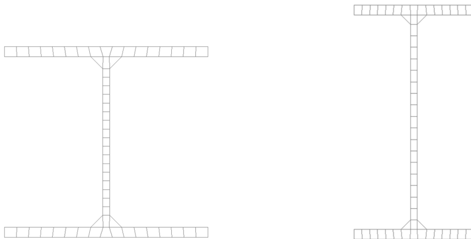
Figure 4-2: Maillage du profilé HE200A (à gauche) et maillage du profilé IPE200 (à droite)
