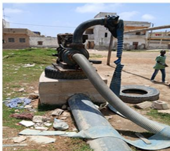
Motopompe connectée aux tuyaux pour l'évacuation des eaux
