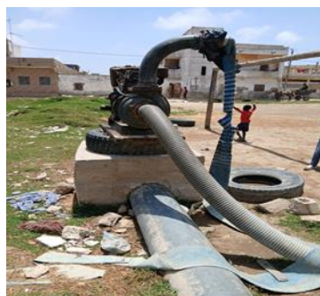
Figure 16 : Motopompe connectée aux tuyaux pour l'évacuation des eaux
