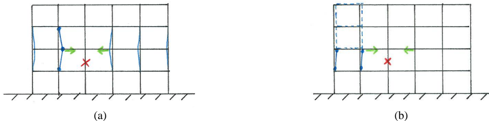
Fig. I.27 : Formation d'un mécanisme plastique dans la partie indirectement affectée – mécanisme de « poutre » à trois rotules (a) et mécanisme de panneau (b)
