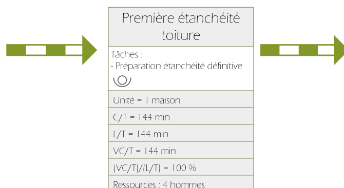
FIGURE 6.36 – Processus relatif à la première étanchéité du bâtiment à la fin du montage de ce dernier
