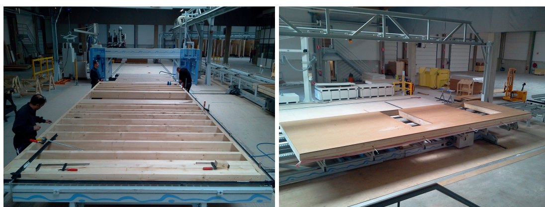
FIGURE 6.20 – Assemblage de la structure d'un mur sur la table 1
