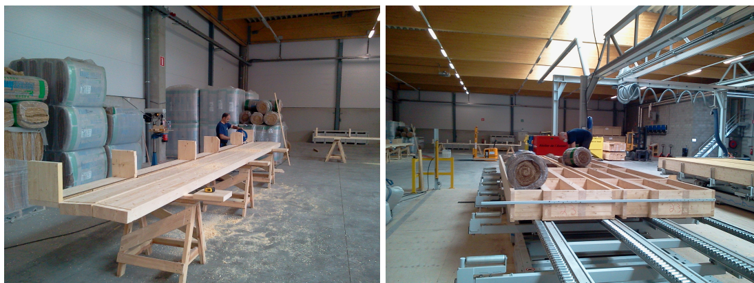
FIGURE 6.25 – Préparation des solives de plancher sur les tréteaux FIGURE 6.26 – Remplissage d'isolant de deux planchers en parallèle sur la table 2
