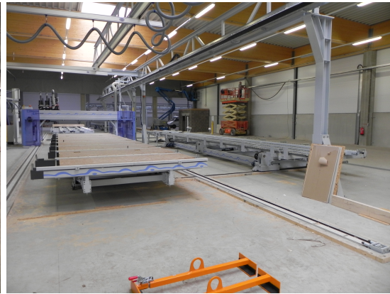
FIGURE 6.10 – Tables d'assemblage et pont multifonction - WEINMANN WBZ 120
