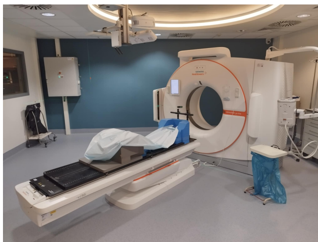
FIGURE 6.6 – Photographie du simulateur du CHU de Tivoli. On peut également y observer des moyens de contentions pour le traitement d'un sein, où la patiente est allongée sur un plan inclinée et a les bras relevés qui saisissent la barre derrière sa tête.
