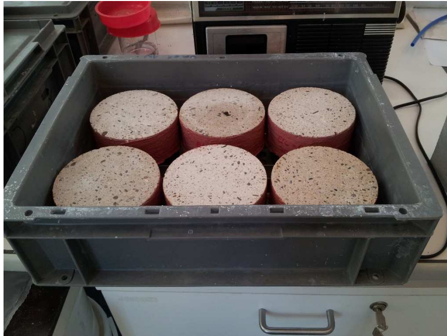
Photo 12 : Échantillons après 35 jours dans la solution de NaCl
