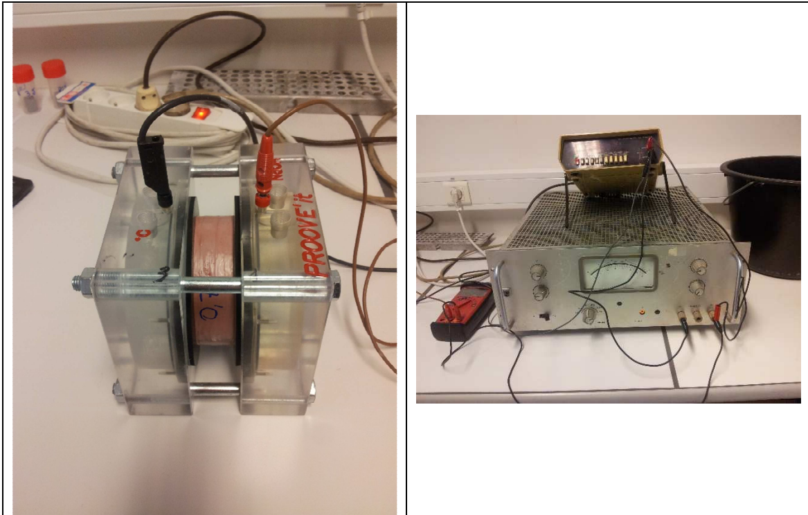
Photo 15 : Cellule de diffusion accélérée et générateur
