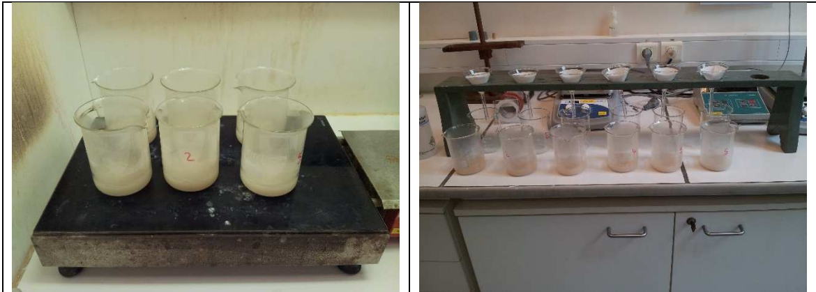
Photo 14 : Mise à ébullition et filtrage
