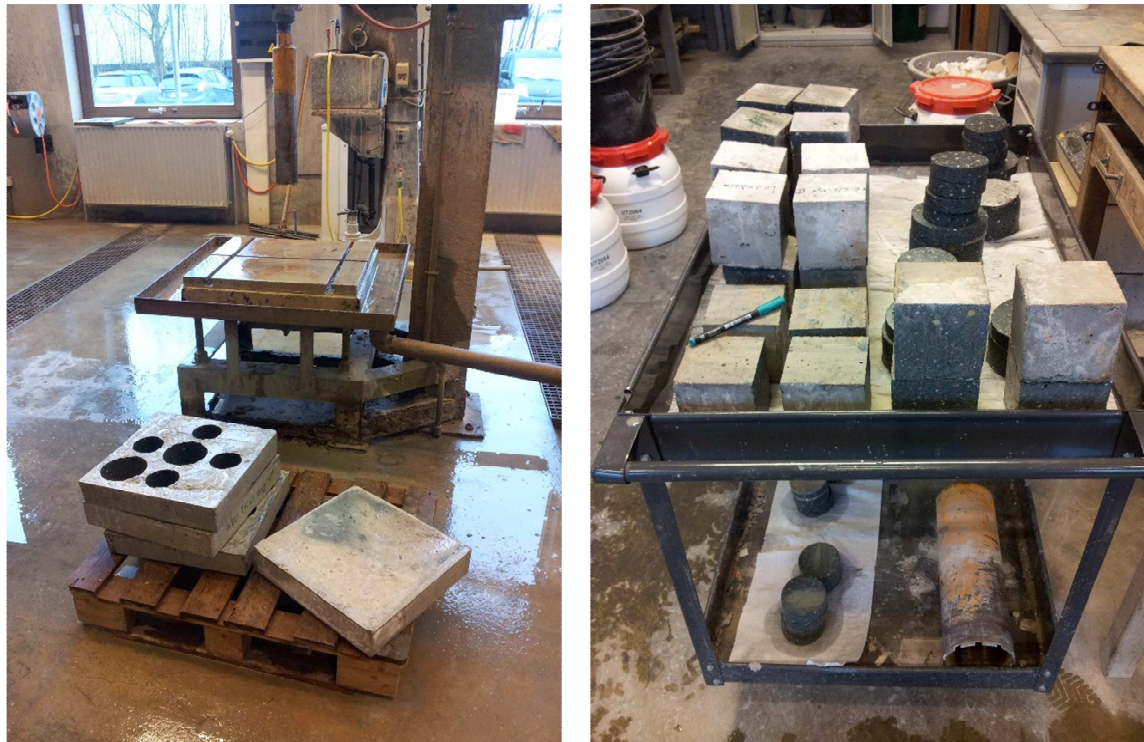
Photo 8 : Confection (carottage et sciage) des échantillons
