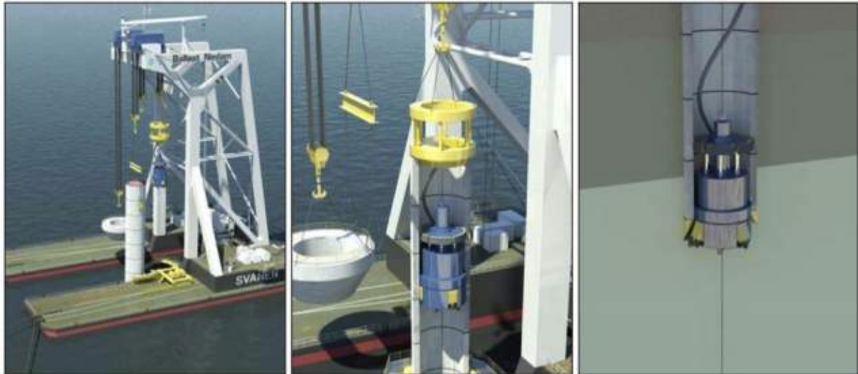
Figure 7 - Conception de mono-pieu foré en béton 6
