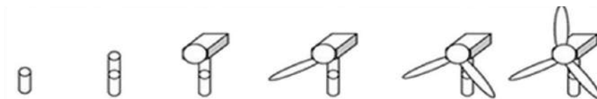
Figure 49 – Processus d'assemblage pour stratégie « single blade » [Petcu, 2011]
