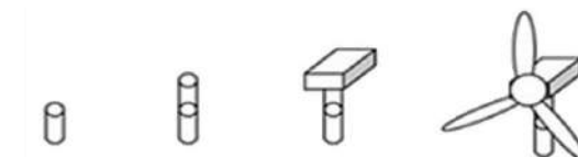
Figure 51 - Processus d'assemblage pour stratégie « rotor star » [Petcu, 2011]
