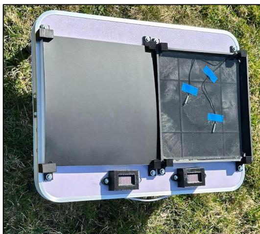
Figure 27. Cibles de calibration du capteur thermique
