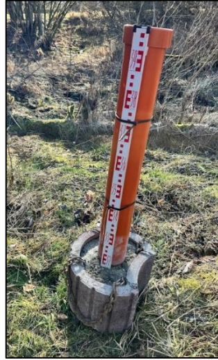
Figure 36. Montage réalisé pour placer les Divers dans les bassins
