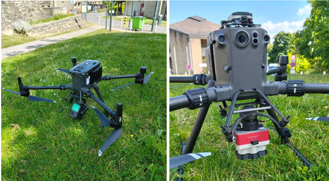
FIGURE 27 – Photos du drone « Dji Matrice 300 Series » utilisé avec le capteur LiDAR « Dji Zenmuse L1 » (à gauche) et le capteur multispectral « RedEdge-P » (à droite).
