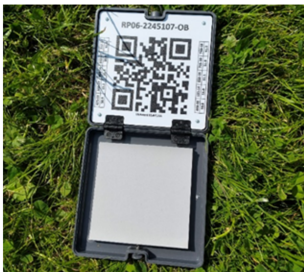
FIGURE 29 – Cible de calibration spectrale utilisée pour calibrer les mesures multispectrales effectuées.
