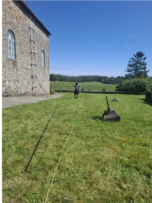
Figure : Acquisition manuelle à l'église d'Ivoy par aller-retours à une distance fixe (4m du mur, angle vertical 20°). On peut voir les guides au sol et la perche.
