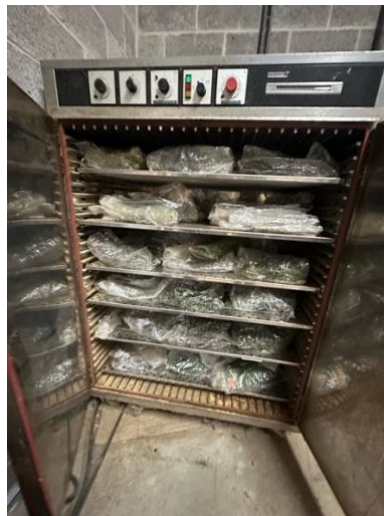
Figure 18. Étuve ventilée utilisée pour le séchage des échantillons de biomasse (ferme expérimentale de Gembloux Agro-Bio Tech).
