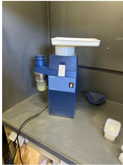
Figure 19. Broyeur utilisé pour la préparation fine des échantillons secs avant conditionnement en cupule et analyse NIRS.
