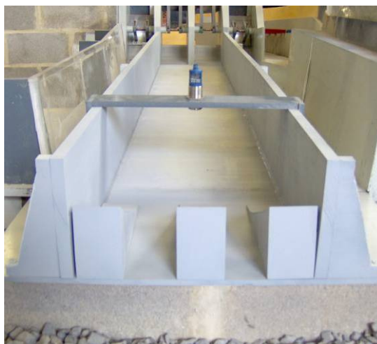
Figure 35 : Sonde de distance sur l'évacuateur de crue, à l'amont des indentations
