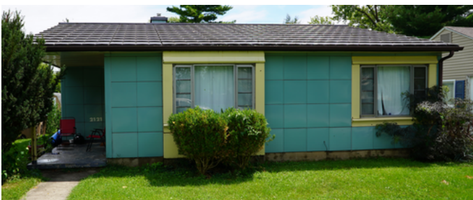
(Image 13) Maison Lustron, États-Unis, 1948. Prototype d'habitat léger en acier émaillé livré à plat et monté sur site. (Wikipedia contributors, 2025)
