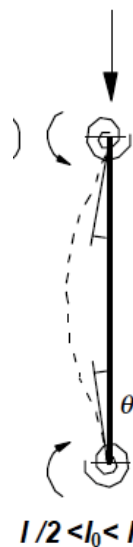
Figure 25 : Longueur de flambement
