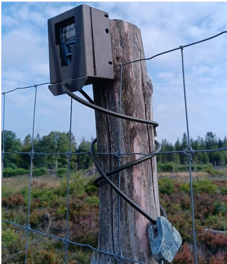
Figure 6 - Caméra Boly (Guard S2G2060-T) placée dans un boîtier sécurisé par un cadenas.
