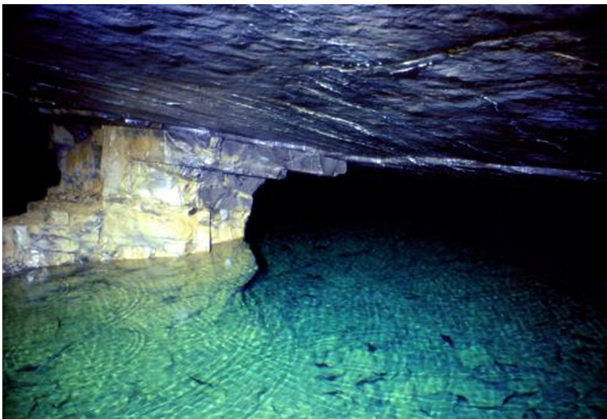
Figure 53: Galerie d'extraction souterraine du marbre noir de Golzinne partiellement inondée Source : Tchorski, reportage photographique sur la carrière de Golzinne ( https://tchorski.fr/3/1597.htm ).
