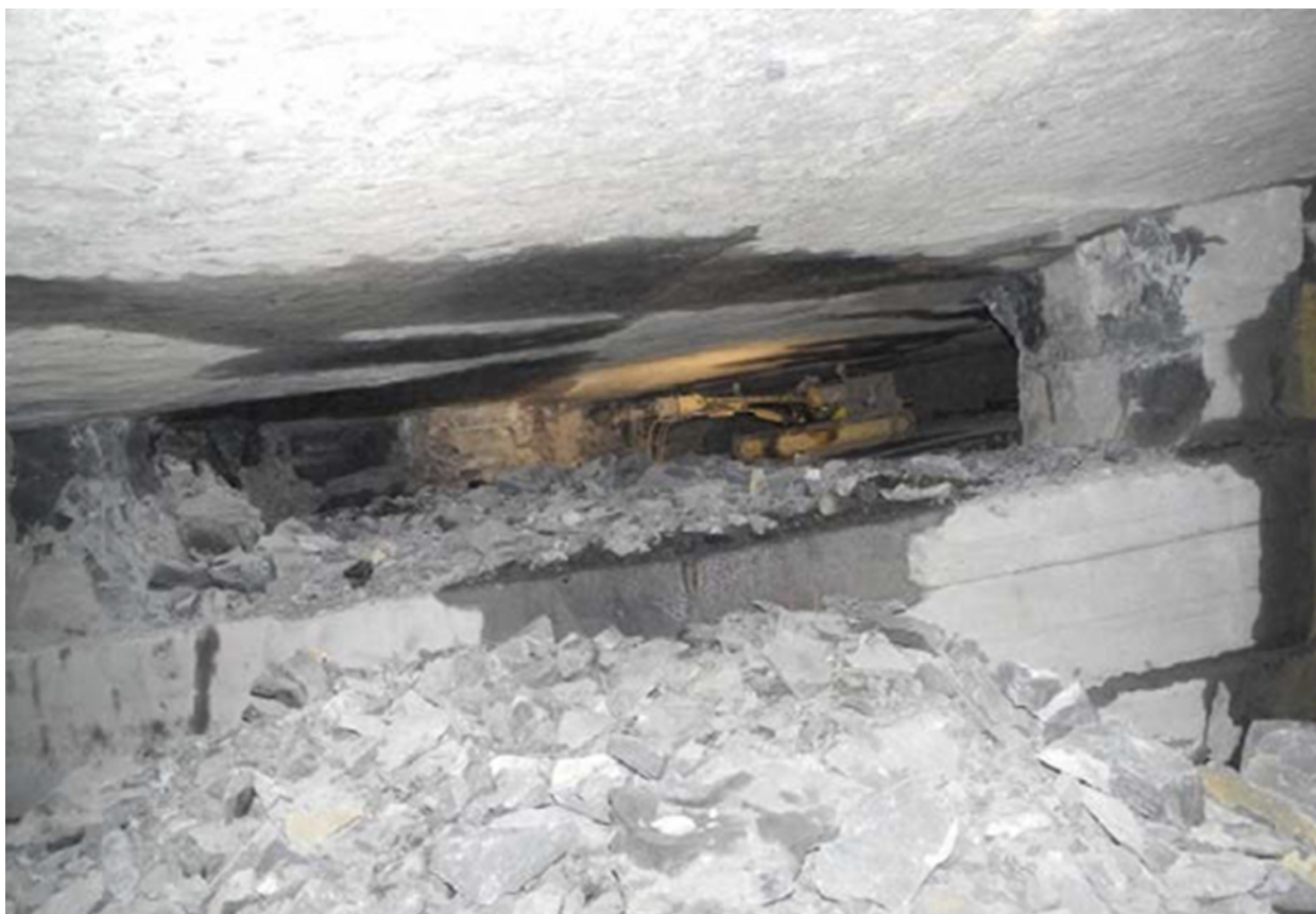
Figure 52: Galerie d'extraction souterraine du marbre noir de Golzinne partiellement remblayée Source: Tchorski, reportage photographique sur la carrière de Golzinne ( https://tchorski.fr/3/1597.htm ).
