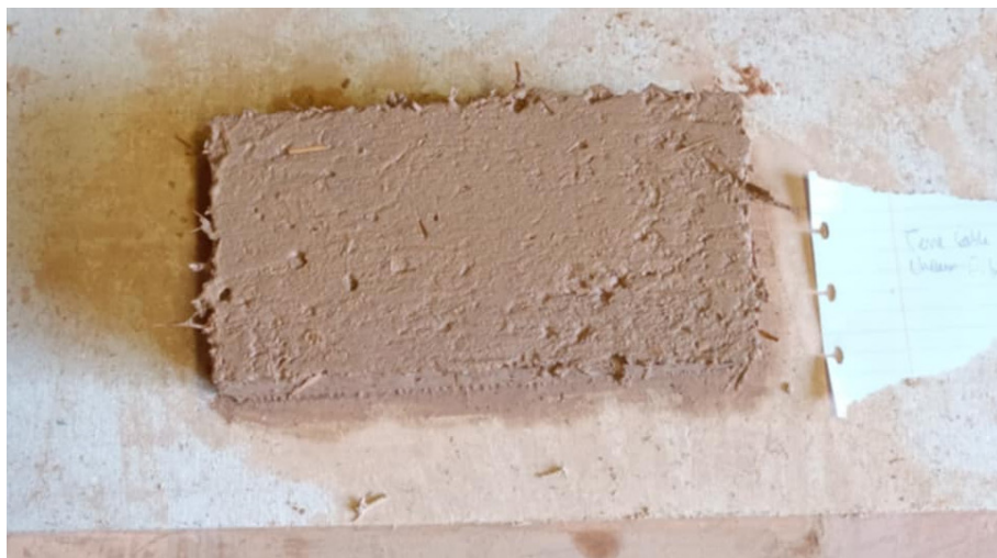
Démoulage et photo d'une brique en mélange terre-sable-chaux-fibre Photo d'Aliciane De Paoli
