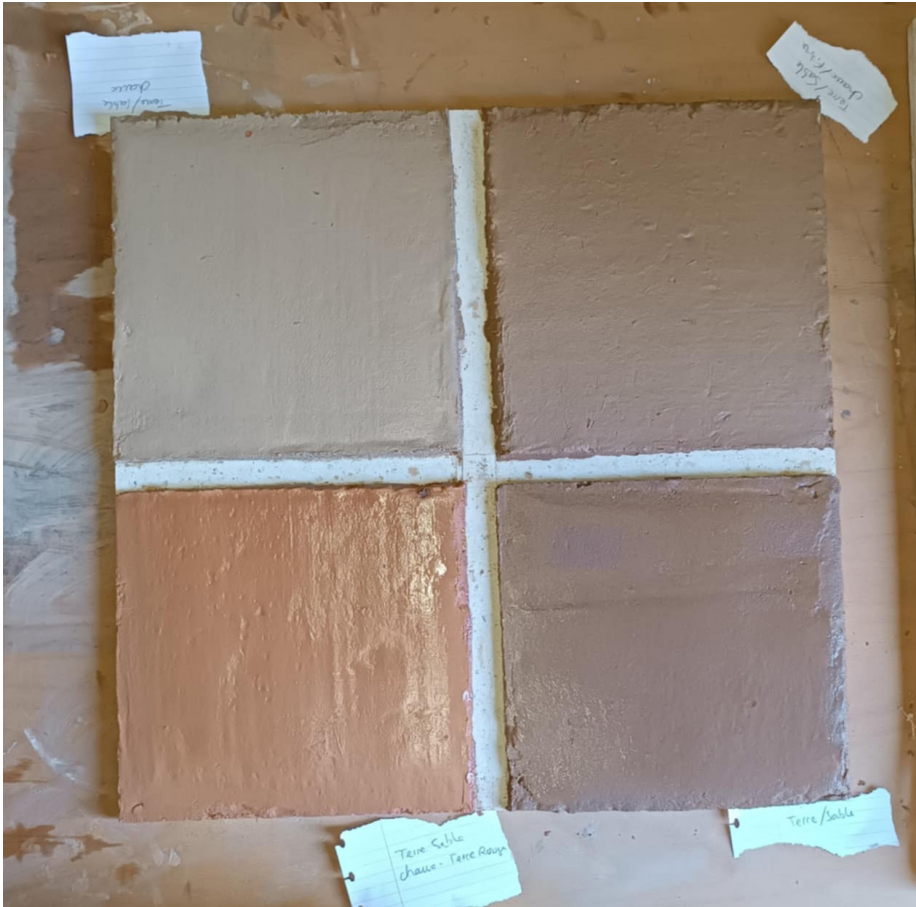
Test d'enduits à base de terre, sable, chaux et fibre Photo d'Aliciane De Paoli
