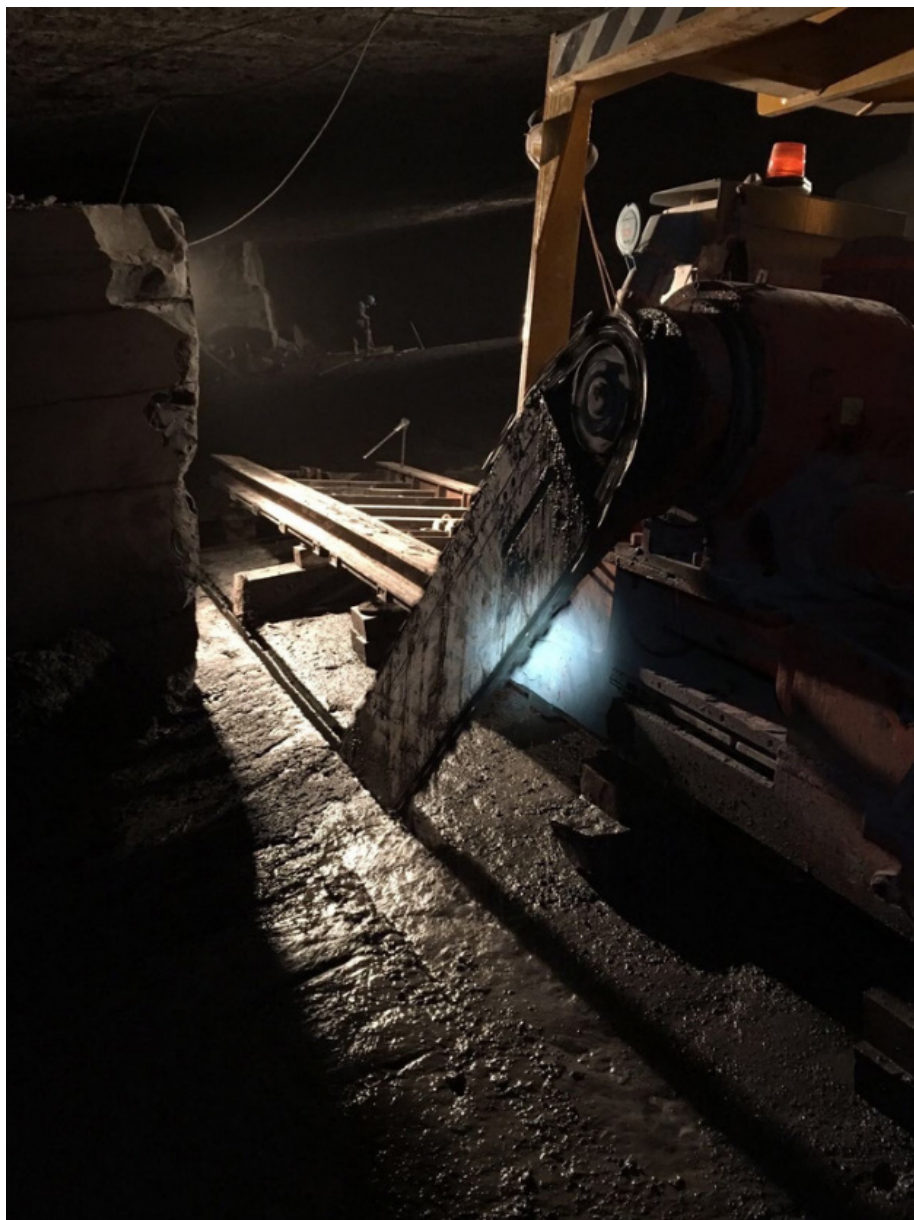
Sciage d'un bloc de marbre Carrière de Golzinnes, actuel
