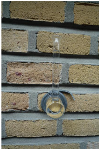
Figure 25 : Test de perméabilité à l'aide de la pipe de Karsten. [Willem.2012]
