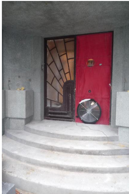
Figure 30: Mesure de l'étanchéité à l'air par la méthode « Blower Door ». [Willem.2012]
