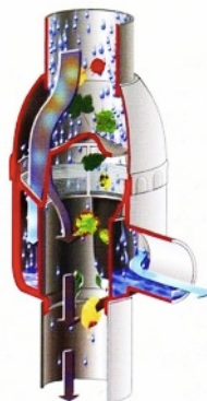
Figure 26: Filtre autonettoyant (source : Vu, 2006)
